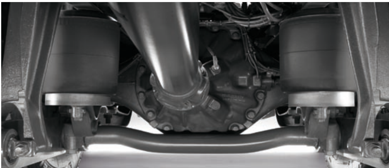
В базовой комплектации седельные тягачи с колесной формулой 4 x 2 и 6 x 2 оснащаются пневматической подвеской с двумя пневморессорами, расположенными непосредственно за мостом, для улучшения динамики движения и снижения колебаний кузова.
