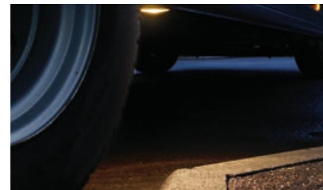
Устанавливаемые в новом Atego на заказ рабочие фары для облегчения маневрирования освещают в темноте зону вокруг задних колес. Это облегчает водителю маневрирование и предотвращает возникновение возможных повреждений автомобиля или окружающих предметов.
