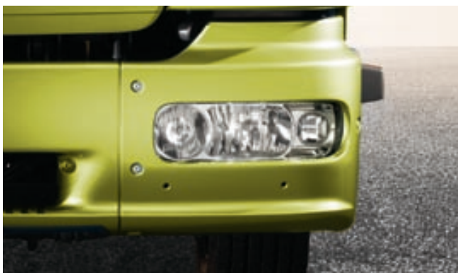
Фары нового Atego с прозрачными рассеивателями отличаются не только отличным дизайном, но и обеспечивают оптимальную видимость и безопасность при выполнении развозных задач. Указатели поворота в монохромном исполнении встроены в решетку радиатора.
